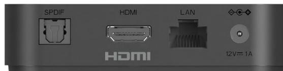
1. Connectez la TV Box au téléviseur à l'aide du câble HDMI fourni.
